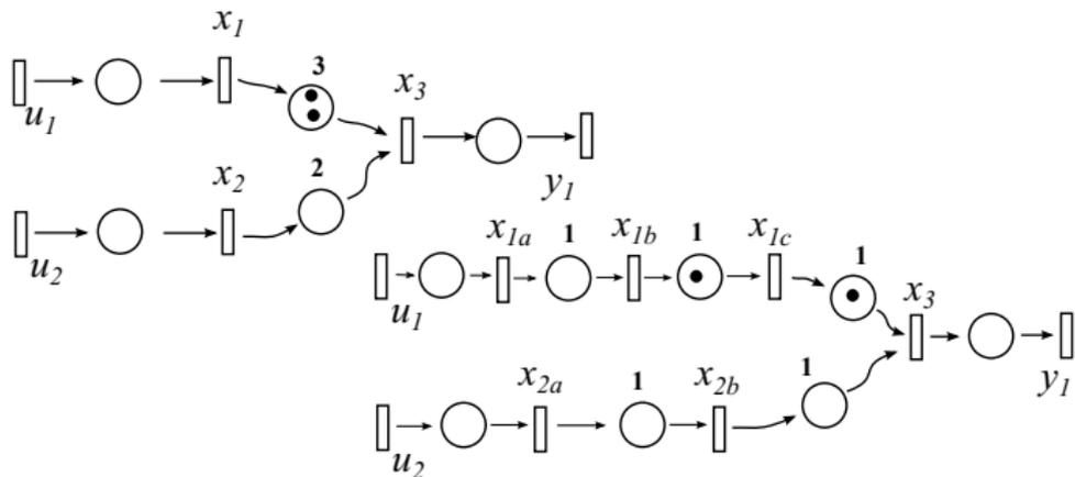
**Remarque :** le marquage initial décrit l'état du système à  $t = -\infty$ . Ce marquage peut être différent à  $t \neq -\infty$  (fonctionnement au plus tôt). Par exemple, le jeton dans  $x_{1b} \rightarrow x_{1c}$  à  $t = -\infty$  sera dans la place  $x_{1c} \rightarrow x_3$  à  $t \neq -\infty$ . D'où l'équivalence.
